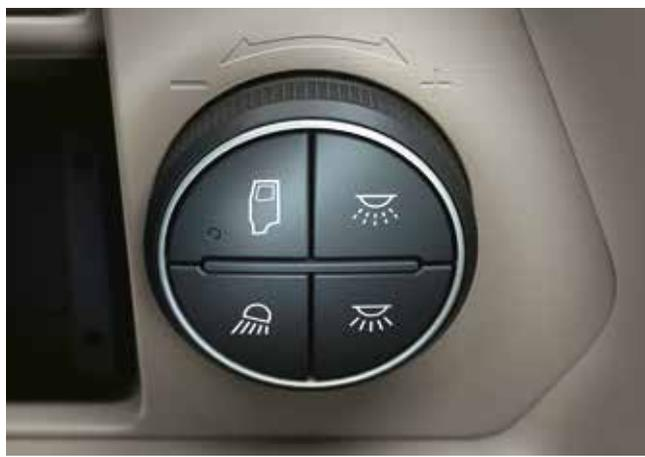
La commande rotative contrôle la sélection et l'intensité de l'éclairage intérieur de la cabine.
