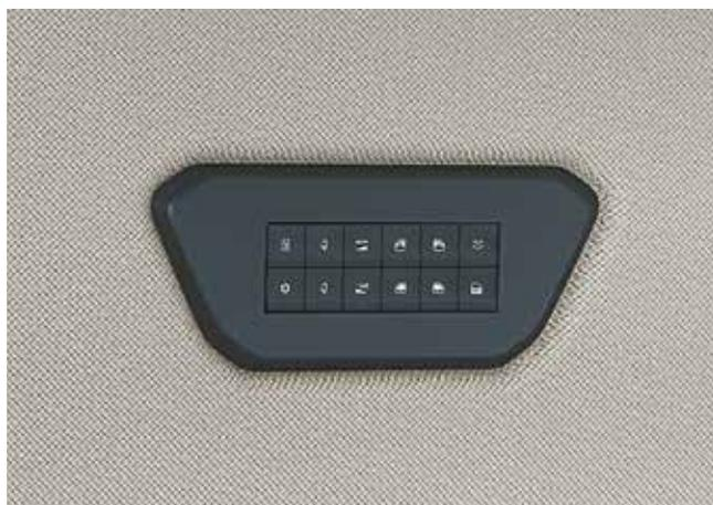
Le module de commande situé au centre de la couchette inférieure permet au conducteur de gérer rapidement et simplement l'éclairage de cabine, la température de l'habitacle, la radio et les vitres. Ces fonctions sont aussi disponibles depuis l'application mobile MYIVECO Easy Way.
