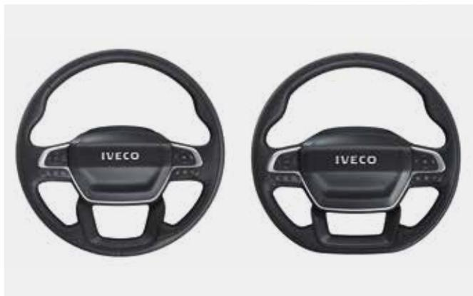
Volant multi-fonctions disponible en cuir. La jante du volant dispose d'un méplat pour plus d'espace aux jambes (méplat présent suivant configuration d'essieux et d'empattement).
