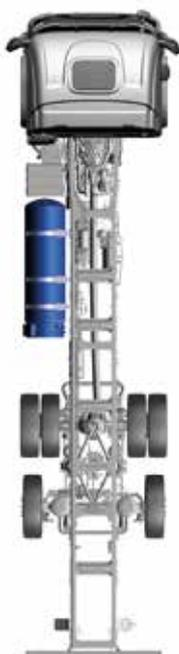
Réservoir GNL à gauche, disponible en combinaison avec un réservoir GNL à droite.
