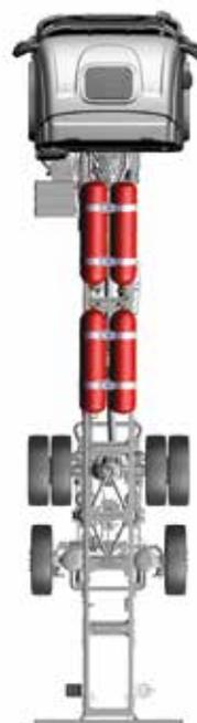
Réservoirs GNC sur le châssis, disponible en combinaison avec :
